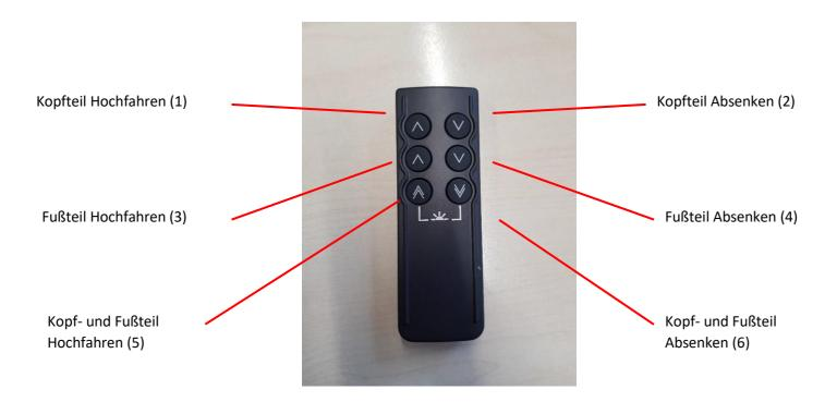
Bei gleichzeitiger Betätigung der Tasten (5 und 6) wird das Licht am Empfänger angeschaltet
