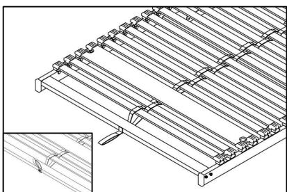
Drehen Sie das überstehende Ende zu einer Schlaufe. Legen Sie diese Schlaufe über das Anfangsstück. Am Kopf- und Fußteil befestigen Sie den Gurt mit je einer Schraube (C) und einer Scheibe (D).
