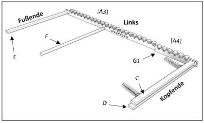
Legen Sie den montierten, linken Außenholm vor sich auf die weiche Unterlage und schrauben Sie nun die Fußsprosse [E], die Mittelsprosse [F] sowie die untere Kopfsprosse [D] mit der Schraube [M] am Außenholm fest. Schrauben Sie nun auch die obere Kopfsprosse [C] am Innenholm [G1] fest. Verwenden Sie den beiliegenden Inbusschlüssel [R].
