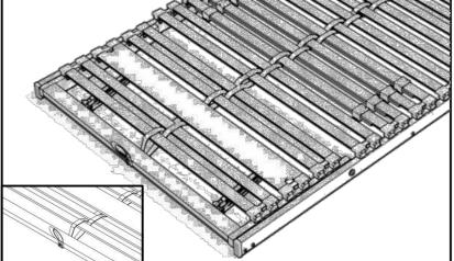
Drehen Sie das überstehende Ende zu einer Schlaufe. Legen Sie diese Schlaufe über das Anfangsstück. Am Kopf- und Fußteil befestigen Sie den Gurt mit je einer Schraube (C) und einer Scheibe (D).
