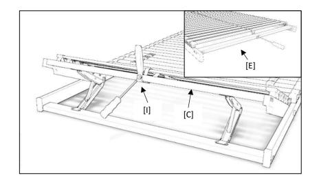
Richten Sie den Textilgurt [I] mittig aus. Befestigen Sie diesen mit den Scheiben (4mm) [Q] und den Schrauben 3,5x17mm [O] an der oberen Kopfsprosse [C] und der Fußsprosse [E]. Die Gurtenden werden dabei jeweils unter den Sprossen durchgeführt.
