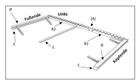
Legen Sie das linke, vormontierte Seitenteil vor sich auf die weiche Unterlage und schrauben Sie nun mit den Schrauben 6,3x50mm [M] die unteren Sprossen [C] an den Außenholm [A]. Schrauben Sie dann die oberen Sprossen [D] an die Innenholme [B1 / B2] unter Verwendung der Schrauben 6,3x50mm [M]. Schrauben Sie die Mittelsprosse [E] unter Verwendung der Schrauben 6,3x50mm ebenfalls an das vormontierte Seitenteil. Verwenden Sie den beiliegenden Inbusschlüssel [R].
