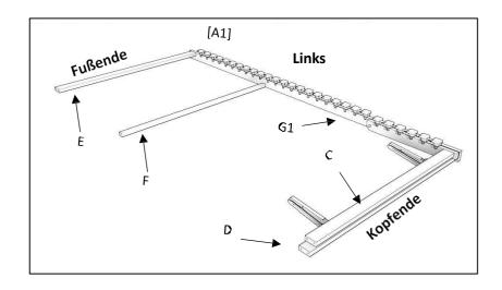
Legen Sie den montierten, linken Außenholm vor sich auf die weiche Unterlage und schrauben Sie nun die Fußsprosse [E], die Mittelsprosse [F] sowie die untere Kopfsprosse [D] mit der Schraube [M] am Außenholm fest. Schrauben Sie nun auch die obere Kopfsprosse [C] am Innenholm [G1] fest. Verwenden Sie den beiliegenden Inbusschlüssel [R].
