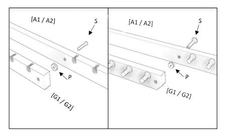
Verbinden Sie die Innenholme [G1 / G2] zusammen mit den Schrauben 8x70mm [S], und den Scheiben (9mm) [P] mit den Außenholmen. Schlagen Sie die Schrauben [S] bündig in die Außenholme ein. Verwenden Sie hierzu geeignetes Werkzeug. Die Bohrungen, bzw. Kunststoffbolzen müssen dabei zum Inneren des Rahmens ausgerichtet sein.
