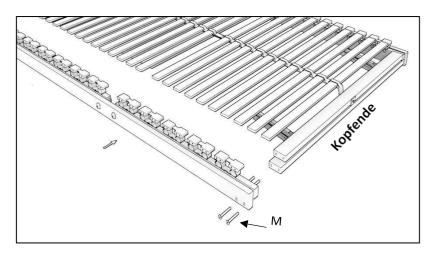
Für eine leichtere Montage schrauben Sie das vormontierte, rechte Seitenteil zunächst nur leicht, mit den Schrauben 6,3x50mm [M], an die Sprossen [C / D]. Somit haben Sie mehr Platz, um die Federleisten in die Kappen [G] zu schieben. Nach der Fixierung der Federleisten in den Kappen können Sie die Schrauben anschließend fest anziehen. Verwenden Sie den beiliegenden Inbusschlüssel [R].
