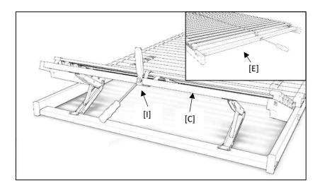
Richten Sie den Textilgurt [I] mittig aus. Befestigen Sie diesen mit den Scheiben (4mm) [Q] und den Schrauben 3,5x17mm [O] an der oberen Kopfsprosse [C] und der Fußsprosse [E]. Die Gurtenden werden dabei jeweils unter den Sprossen durchgeführt.
