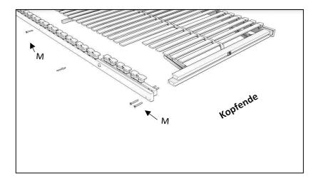
Schrauben Sie den montierten, rechten Außenholm an die Sprossen und stecken die Federleisten in die Kappen. Zur leichteren Montage können Sie die Schrauben 6,3x50mm [M] zuerst nur leicht anziehen. Somit haben Sie mehr Platz, um die Federleisten in die Kappen zu stecken. Anschließend können Sie die Schrauben fest anziehen.
